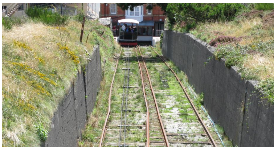
Slika 123: Tirna vzpenjača z vrvnim pogonom in vzponom nad 50% (Aberystwyth, Wales)
