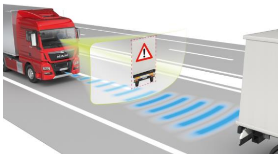
Slika 74: Delovanje sistema samodejnega zaviranja v sili (slika: © MAN Truck & Bus AG)
