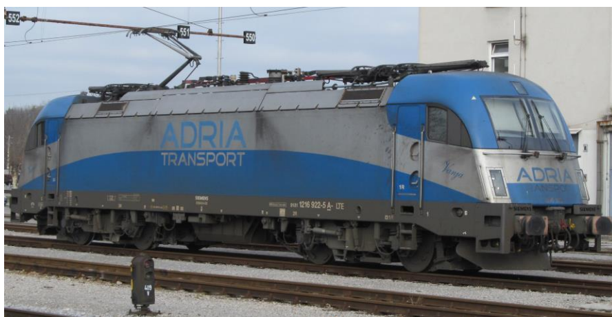
Slika 103: Večsistemska električna lokomotiva Siemens ES64U4
