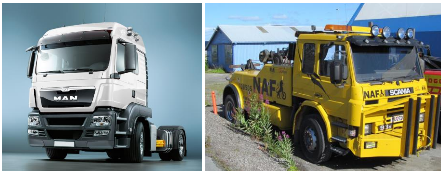
Slika 23: Levo sedlasti vlačilec – nadgradnja BC (slika: © MAN Truck & Bus AG), desno cestni vlačilec – nadgradnja BD
