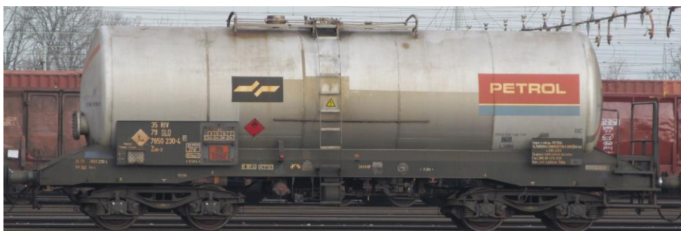
Slika 113: Vagon s cisterno za prevoz kapljev in (podserija Zas-z), prirejen in označen za prevoz vnetljivih snovi
