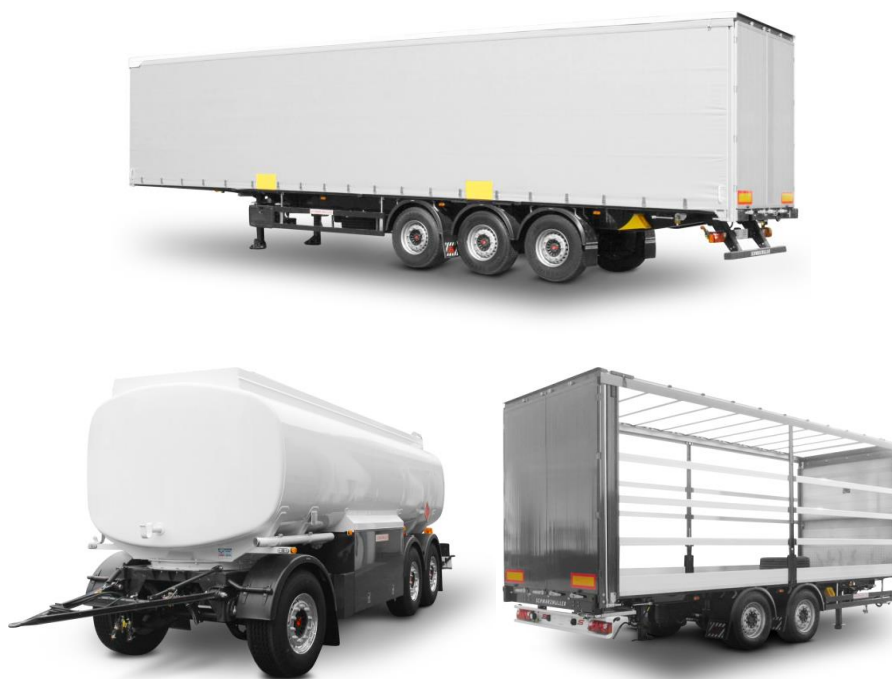
Slika 24: Vozila kategorije O: zgoraj polpriklopnik – DA, spodaj levo priklopnik z vrtljivim ojesom – DB, spodaj desno priklopnik s centralno osjo – DC (slike: © Schwarzmüller Group)
