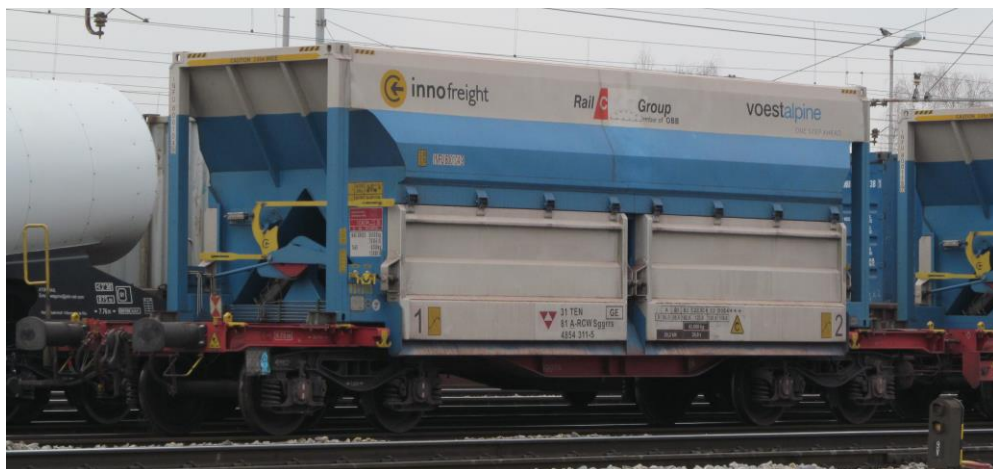
Slika 115: Ploščni vagon podserije Sggrs z dvojn timer za prevoz rude
