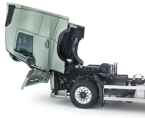
Slika 40: Prekucljiva kabina za dostop do motorja (slika: © Volvo Trucks)
