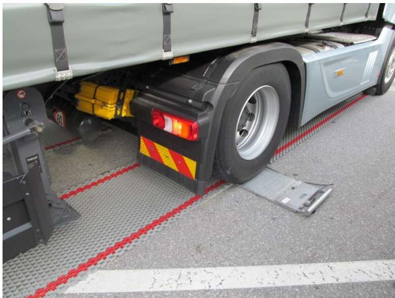
Slika 80: Tehtanje osne obremenitve vozila na prenosni tehtnici
