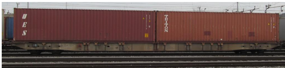
Slika 107: Ploščni vagon podserije Sggnss z naloženima dvema 40' kontejnerjema
