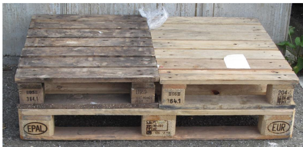
Slika 146: Sklad "euro" palet (spodaj 800 × 1200 mm, zgoraj 800 × 600 mm)
