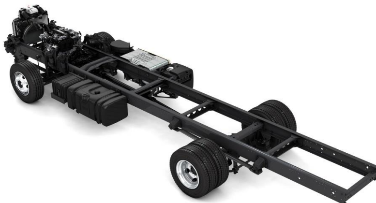
Slika 35: Lestveni okvir z nameščenim pogonskim sklopom in premama (slika: © DAF Trucks N. V.)
