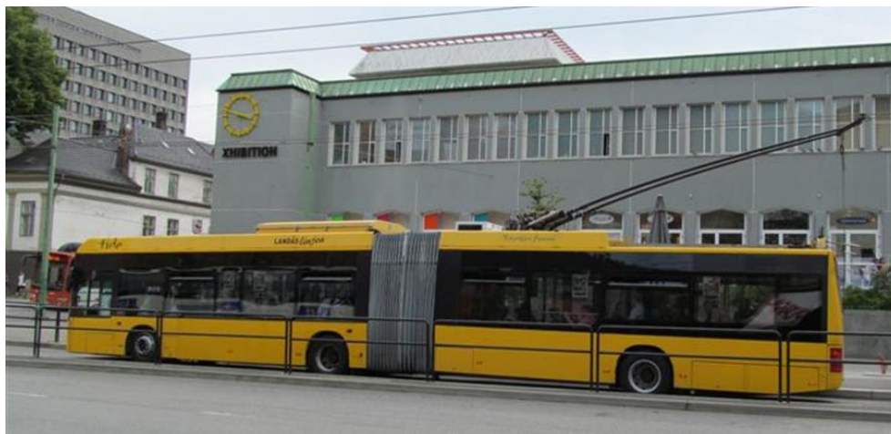
Slika 21: Vozilo na električni pogon s tokovnim odjemnikom kategorije M_2 z nadgradnjo CG– nizkopodni trolejbus (Bergen, Norveška)
