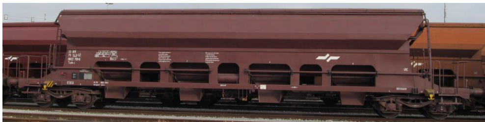
Slika 112: Štiriosni zaprti vagon za prevoz razsutega tovora z gravitacijskim praznjenjem (podserija Tadds-z)
