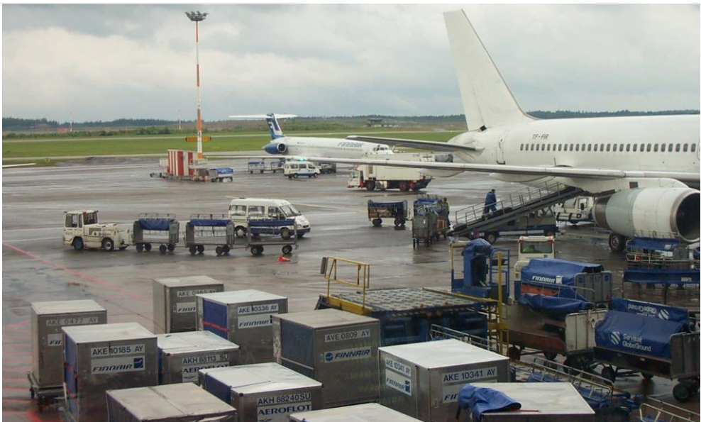
Slika 144: Oprema za talno podporo in ULD enote (EFHK, Vantaa, Finska)
