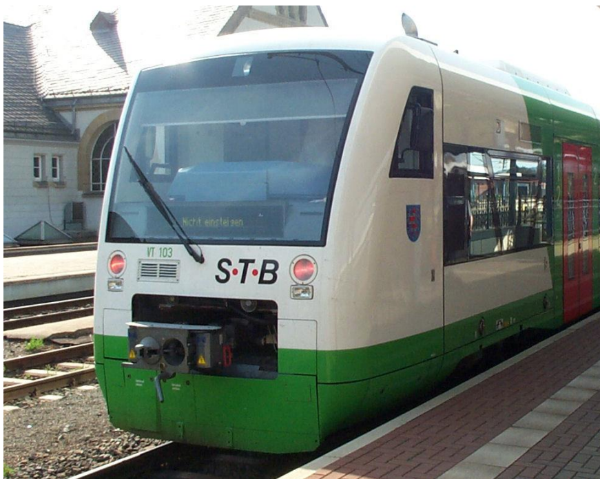
Slika 130: Dieselmotorna potniška garnitura s spenjalno napravo tipa Scharfenberg (Süd-Thüringen-Bahn, Nemčija)
