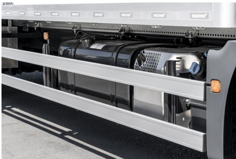
Slika 77: Bočna zaščita na tovornem vozilu (slika: © MAN Truck & Bus AG)
