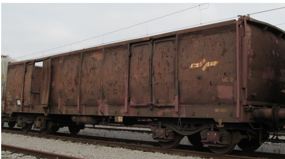
Slika 110: Štiriosni odprti škatlasti vagon podserije Eas-z
