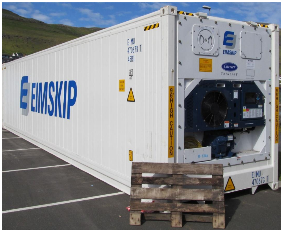
Slika 153: Kontejner z napravo za zagotavljanje stalne temperature ("reefer")
