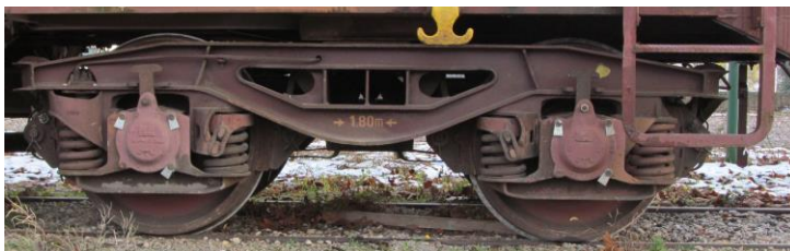
Slika 121: Podporni voziček tovornega vagona
